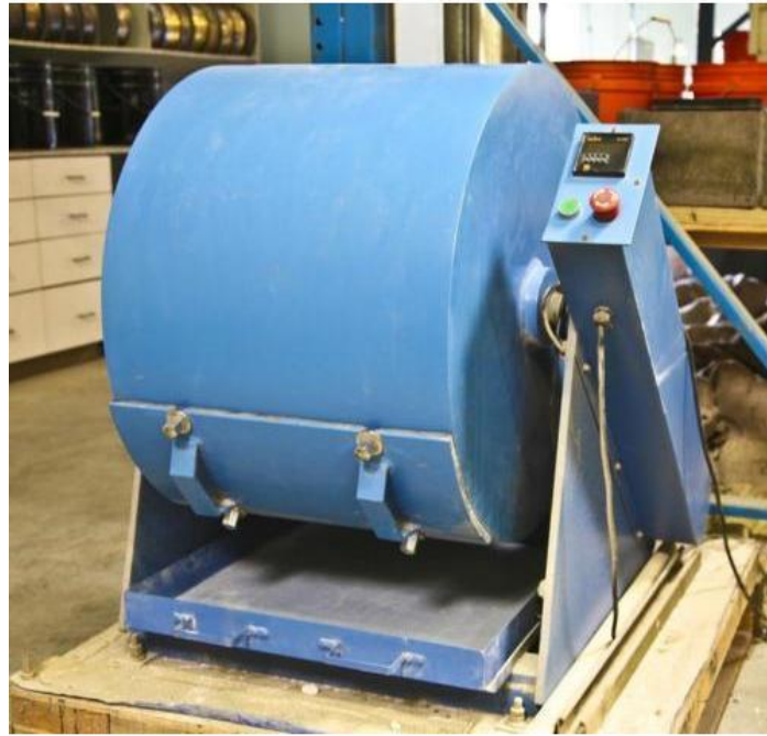
Figure 3.7. Los Angles Abrasion Test Machine
